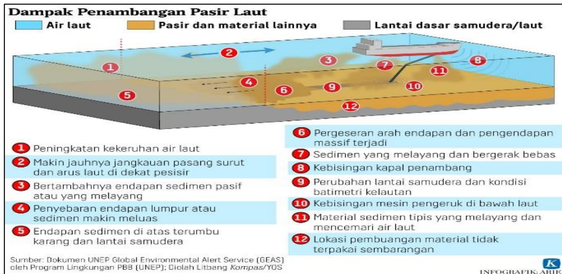
Gambar 3. Dampak Penambangan Pasir Laut
